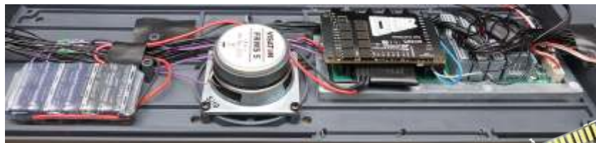
G-Spur „Allegra“ (RhB ABe) nach Umrüstung mit Supercap-Energiespeicher, Lautsprecher, und Decoder MX695LS.
