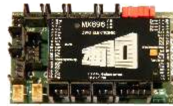
Spezial-Lokplatine für die TrainLine HSB Mallet; oben mit aufgestecktem Decoder MX696S.
