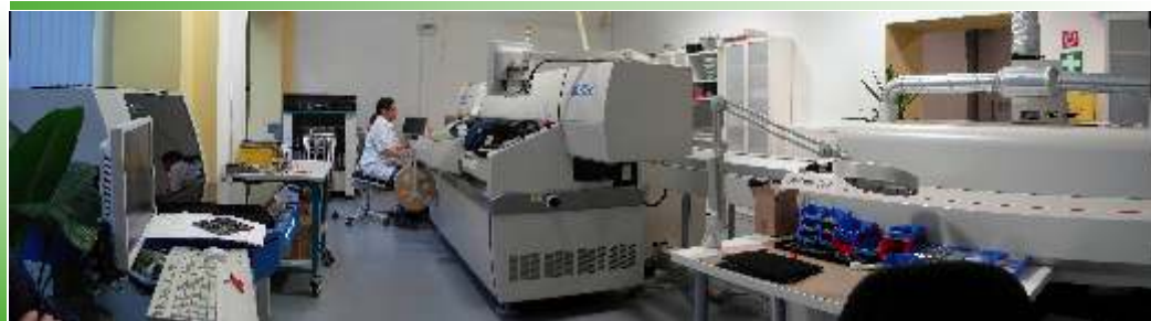
ZIMO Produktion Maschinenraum: zwei Bestückungs-Automaten, Reflow-Lötofen, Lötpastendrucker, AOI-Gerät
