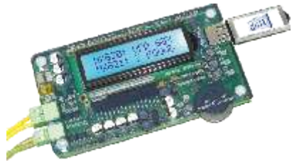
Decoder-Update-Gerät MXULFA mit ZIMO Stick
