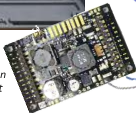
G-Spur „Allegra“ (RhB ABe) nach Umrüstung mit Supercap-Energiespeicher, Lautsprecher, und Decoder MX695LS.
