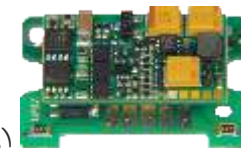
Lokplatinen mit aufgestecktem Miniatur-Sound-Decoder MX648P16
