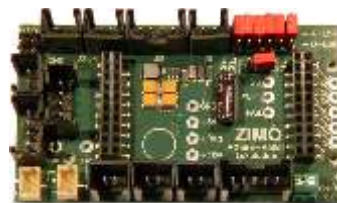
Spezial-Lokplatine für die TrainLine HSB Mallet; oben mit aufgestecktem Decoder MX696S.
